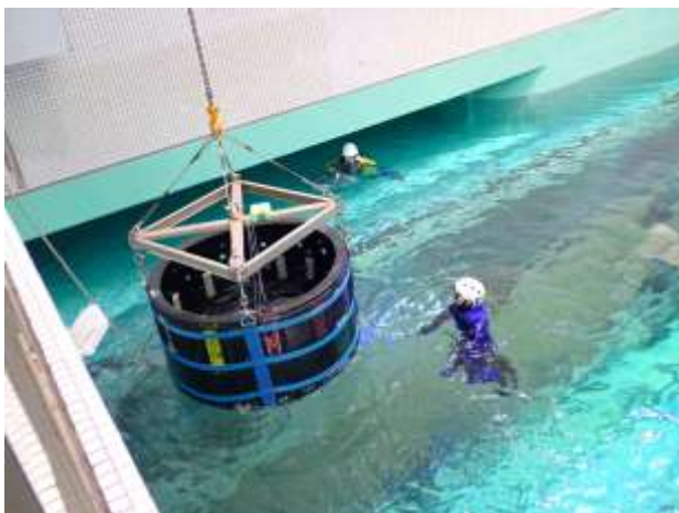
搬入の時は活魚タンクをクレーンで吊りながら水槽へ移動しました。
